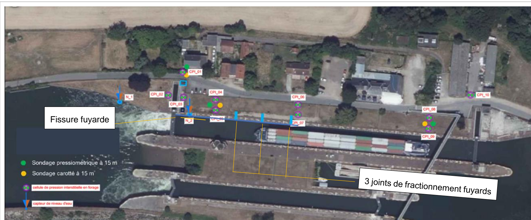
Figure 62 : Localisation des principales fuites au travers du bajoyer rive droite
